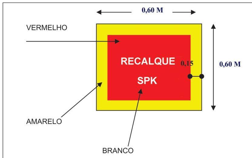
**OBSERVAÇÃO: O REGISTRO DE RECALQUE DO SISTEMA DE HIDRANTES DEVERÁ SER SINALLIZADO DA MESMA FORMA ACIMA, PORÉM SUBSTITUINDO-SE AS LETRAS "SPK" POR "HID".**
